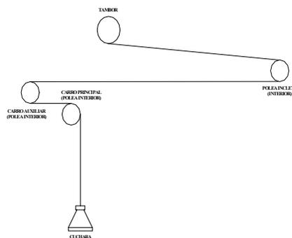
Figura 1: Esquema general cables maniobra cuchara
